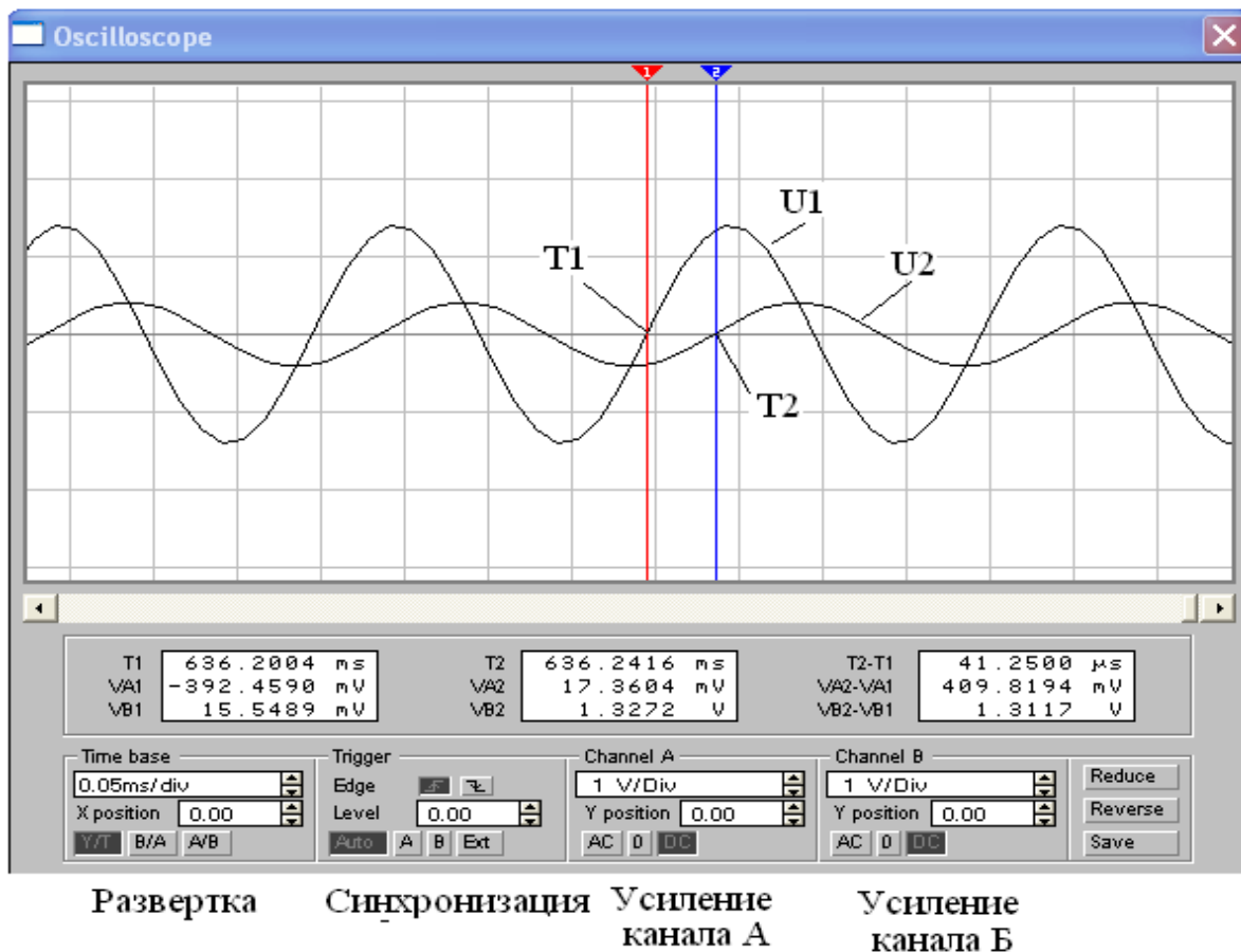
Рис. 2.13. Лицевая панель виртуального осциллографа
