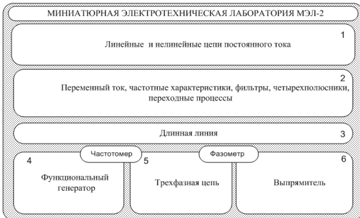
Рис.В.2. Эскиз наборного поля МЭЛ-2 Внешними приборами могут служить двухканальный осциллограф, мультиметр,
